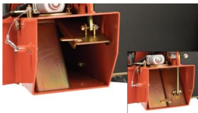
Système Dual Deflector Air Flow: flux d'air divisé à gauche
