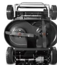
Un sens de rotation différent assure une réception centrale
