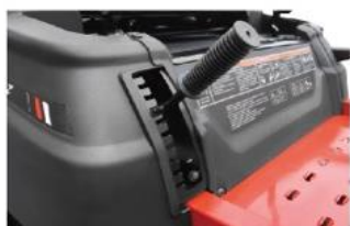
Hauteur de coupe 25 – 100 mm avec 10 positions
