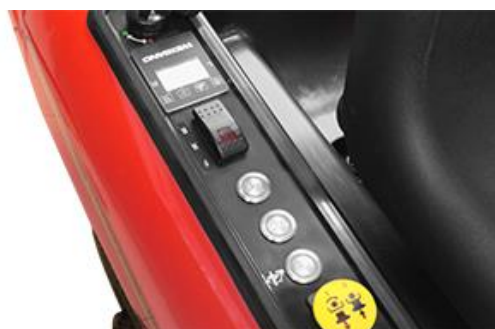
Panneau de commande (frein de lames, LED, cruise control & tondre à marche arrière)
