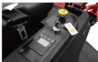
Panneau de commande convivial (écran LCD monte temps de travail, vitesse de roues, état du capteur de sécurité, capacité de force)
